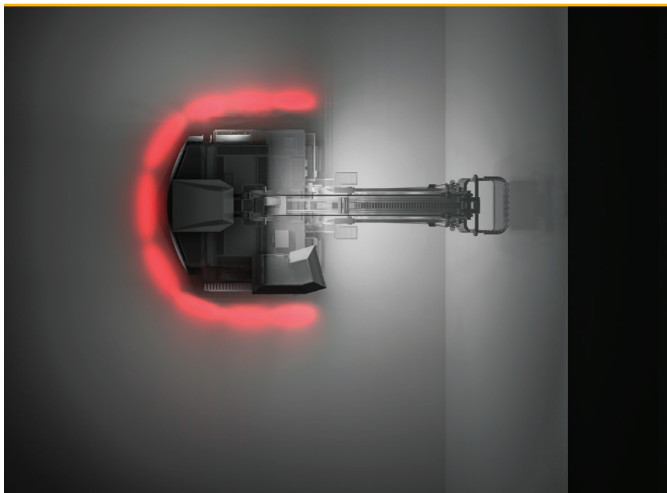
Vista superior de una pala eléctrica de cable equipada con nueve luces de peligro
